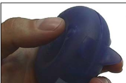
bouton de sélection marche/arrêt/ expression à l'arrière de l'appareil
