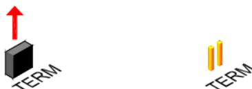
Indien de bekabeling in ster- of boomstructuur uitgevoerd is, wordt er enkel een afsluiter geplaatst op de module die aan het beginpunt van de kabel aangesloten is en op de module die op het uiteinde van de langste kabel aangesloten is.
