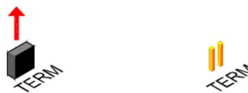
Ponga sólo un jumper en el último módulo del cable MÁS LARGO y no en todos los módulos si utiliza diferentes modelos de cableado (árbol, estrella, bucle...).
