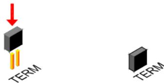
Entfernen Sie die Steckbrücke bei allen anderen Modulen.
