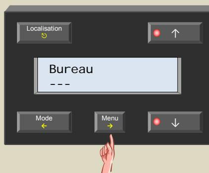
19. Sélectionnez le capteur dans le couloir (afin de pouvoir constituer le thermostat différentiel) avec le poussoir ↑ ou ↓.
