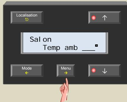
7. Mesurez la température ambiante de la pièce à l'aide d'un thermomètre et entrez la valeur avec le poussoir ↑ ou ↓.
