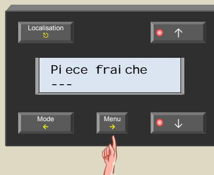
13. Sélectionnez le capteur dans la chambre à coucher (afin de pouvoir constituer le thermostat différentiel) avec le poussoir ↑ ou ↓.
