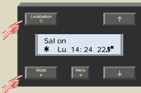
Il est possible d'afficher les températures minimale et maximale de chaque capteur, tout comme la durée d'activation du chauffage/climatiseur dans un mode particulier (confort, régime de jour/nuit, antigel).
