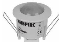
Grâce à l'horloge astronomique, il est possible de programmer le VMBPIRO et le VMBPIRC en fonction de l'heure. Les deux modules permettent de détecter simultanément des mouvements pour un signal de passage (2 canaux de sortie indépendants) et des mouvements en fonction de la luminosité pour le pilotage de la lumière (encore 2 canaux de sortie indépendants).
