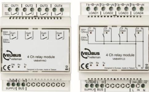
Les modules relais peuvent commuter de l'éclairage, des prises de courant, de l'alimentation LED, etc., puisque qu'ils ont une capacité de commutation de 16 A par canal. (Pour le VMB4RYLD, le courant total dans le module est également max. 16 A). Pour les (très) grands consommateurs, il est conseillé d'ajouter un contacteur entre le module et la charge.
