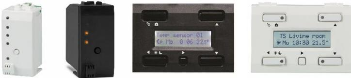
Chacune de ces solutions permet de changer le mode de fonctionnement (jour, nuit, antigel ou confort) par un simple appui sur un bouton-poussoir (p. ex. utiliser le bouton « tout éteindre » pour mettre le chauffage en mode « nuit »). Evidemment, les étapes de programme peuvent être utilisées pour automatiser le changement du mode de fonctionnement (p.ex. mettre le chauffage en mode « jour » tous les matins, etc.).
