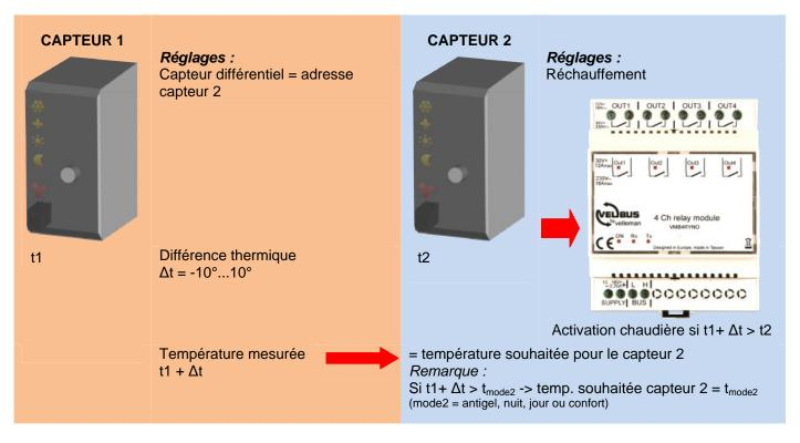
Schéma d'un thermostat différentiel (capteur 2 en mode refroidissement) :
