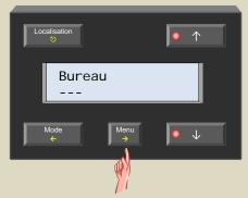
Sélectionnez le capteur dans le couloir (afin de pouvoir constituer le thermostat différentiel) avec le poussoir ↑ ou ↓.
