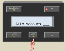
6. Activez ou désactivez le dispositif de contrôle de la tension de la pile avec les poussoirs ↑ et ↓.
