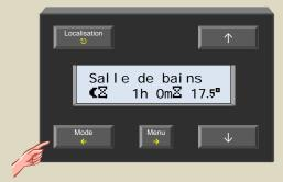
La LED du poussoir Mode clignote et l'afficheur indique un sablier pour indiquer que le mode temporaire SLEEP est activé. Les LED sur le module capteur clignoteront également.
