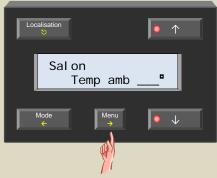
Mesurez la température ambiante de la pièce à l'aide d'un thermomètre et entrez la valeur avec le poussoir ↑ ou ↓.
