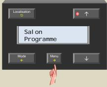
3. Faites défiler le menu avec les poussoirs ↑ et ↓ jusqu'à ce que le sous-menu « Reglages capteur » s'affiche.
