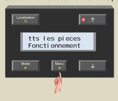
5. Faites défiler le menu avec ↑ et ↓ jusqu'à ce que le sous-menu « Deblocage valve » s'affiche.
