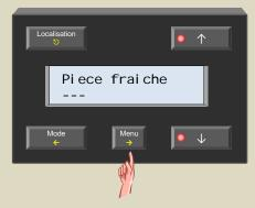
Sélectionnez le capteur dans la chambre à coucher (afin de pouvoir constituer le thermostat différentiel) avec le poussoir ↑ ou ↓.
