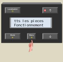
5. Faites défiler le menu avec ↑ et ↓ jusqu'à ce que le sous-menu « Alarme temp. haut » s'affiche.
