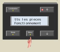
5. Faites défiler le menu avec ↑ et ↓ jusqu'à ce que le sous-menu « Alarme temp. bas » s'affiche.
