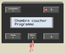
22. Faites défiler le menu avec le poussoir ↑ ou ↓ jusqu'à ce que le sous-menu « Reglages capteur » s'affiche.
