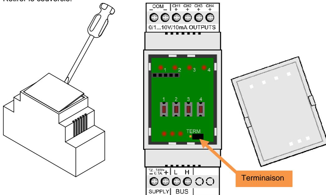
Généralement, le système Velbus ne nécessite que 2 terminaisons "TERM", c.à.d. une sur un module dans la boîte de distribution et une sur le module le plus éloigné de la boîte de distribution.
