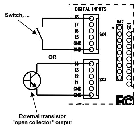
Deze geassembleerde interfacekaart bestaat uit 33 ingangen / uitgangen, inclusief analoge / digitale en een PWM-uitgang.
