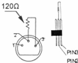
Ein DMX-Abschlusswiderstand empfehlenswert für Installationen, bei denen das DMX-Kabel lang ist oder in einer Umgebung mit vielem elektrischem Rauschen (z.B. Diskos). Der Abschlusswiderstand verhindert Störung des digitalen Steuersignals durch elektrisches Rauschen. Der DMX-Abschlusswiderstand ist nur eine XLR-Buchse mit einem 120Ω Widerstand zwischen 2 und 3, die den XLR-Ausgang des letzten Geräts in der Kette angeschlossen wird. Siehe Abbildung links.
