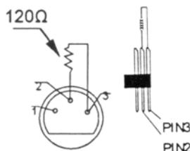
Se recomienda una terminación DMX si el cable DMX debe cubrir una gran distancia o si se usa en un medio ambiente con mucho ruido eléctrico (p.ej. una discoteca). La terminación impide que el ruido eléctrico corrompa la señal de control numérico. La terminación DMX no es más que un conector XLR con una resistencia de  $120\Omega$  de polo 2 a polo 3. Este conector XLR está conectado a la salida XLR del último aparato de la serie.
