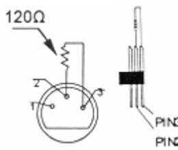
Een DMX terminator is aanbevolen als de DMX-kabel vrij lang is of wordt gebruikt in een omgeving met veel elektrische ruis (vb. een discotheek). De terminator voorkomt corruptie van het digitale controlesignaal door elektrische ruis. De DMX terminator is niets meer dan een XLR-stekker met een weerstand van  $120\Omega$  van pin 2 naar 3. Deze XLR-stekker wordt dan aangesloten op de XLR uitgang van het laatste toestel in de reeks. Zie de illustraties links.
